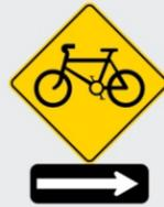
Se utiliza para indicar a los peatones y conductores de vehículos automotores la proximidad del cruce con una vía ciclista. Esta señal debe ser visible para los peatones y automovilistas.
